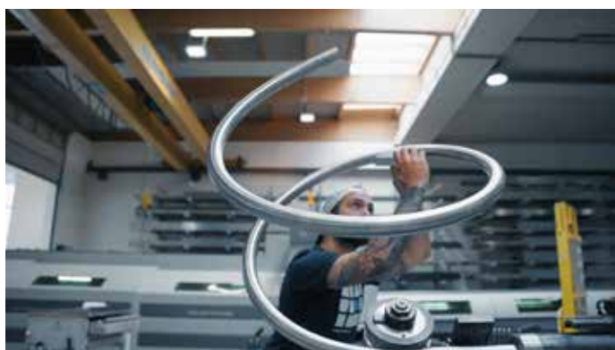
Rohre werden auf Maß gebogen und gewendelt
